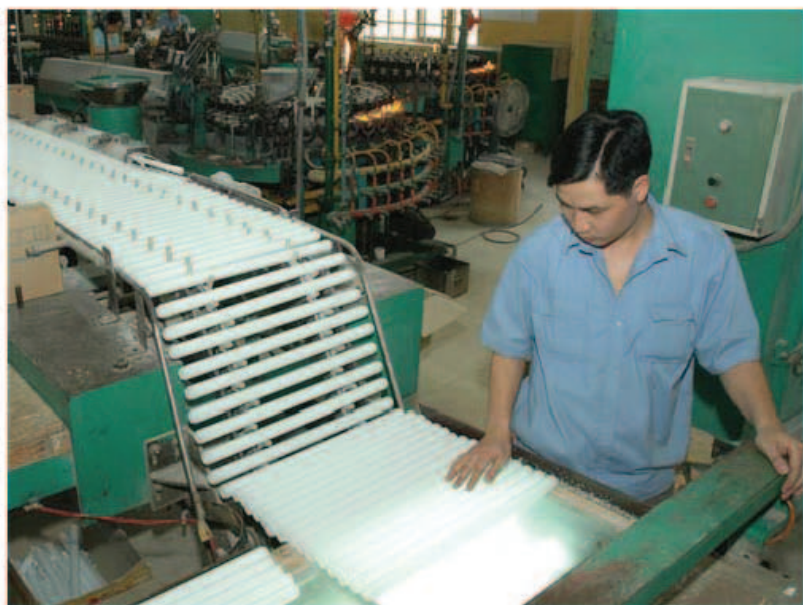
Sản xuất bóng đèn huỳnh quang tại Công ty bóng đèn phích nước Rạng Đông
